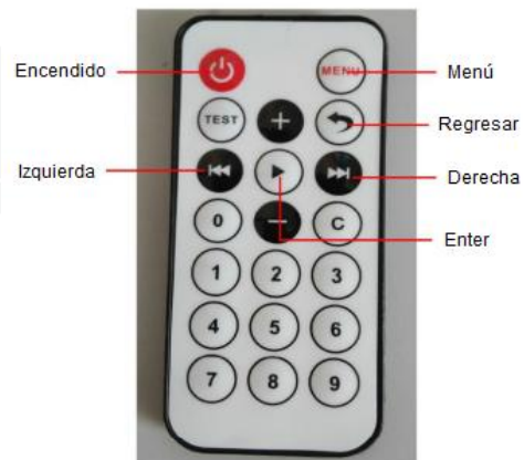
Figura 5. Control remoto infrarrojo
